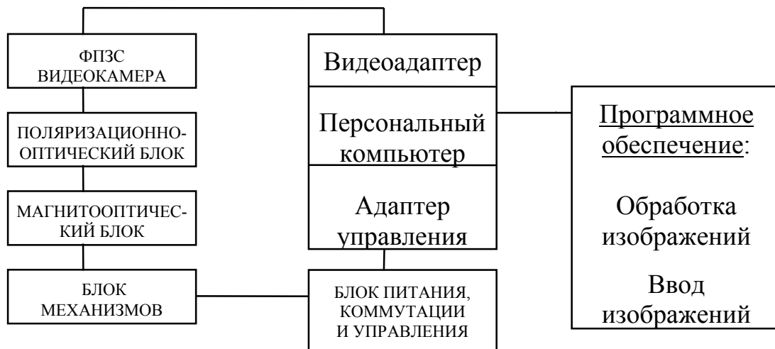
Рисунок 5 - Структурная схема магнитооптического программно-аппаратного устройства для решения задач ТЗИ, записанной на гибких магнитных дисках
