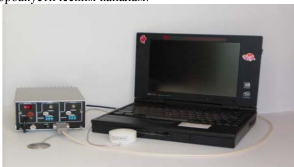
Рисунок 2 – Комплекс виброакустической защиты речевой информации ОЦЗИ-ВА
