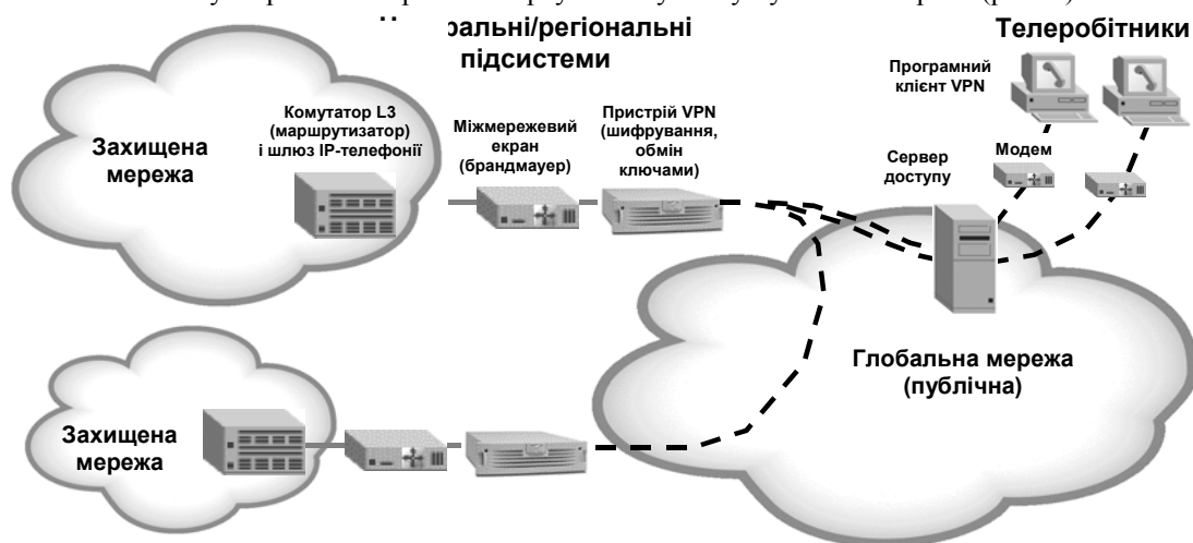
Рисунок 2 – Реалізація VPN в системі телемедицини з організацією віддаленого доступу
