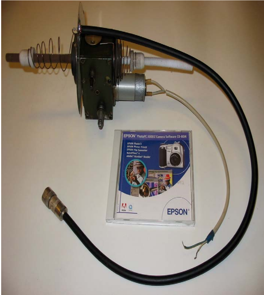
Рисунок – Широкопеленгаційна антена UNF-діапазону
