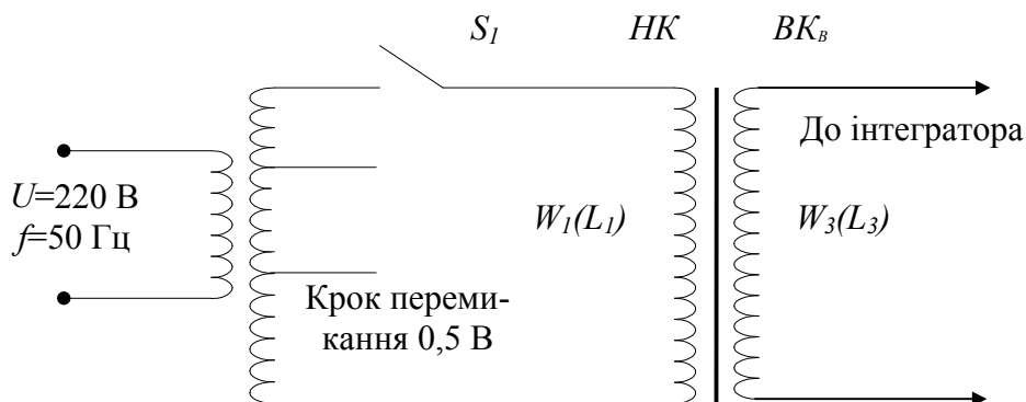
Рисунок 4 – Еквівалентна схема вмикання вимірювальної котушки індуктивності магнітного поля ( W_3, L_3 – число витків і індуктивність вимірювальної котушки магнітної індукції ВК В )
