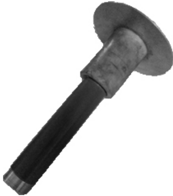
Рисунок 2 – Облучатель линейной поляризации
