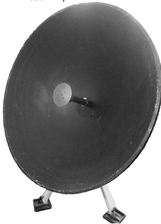
Рисунок 3 – Двухзеркальная антенна с эллиптическим малым зеркалом
