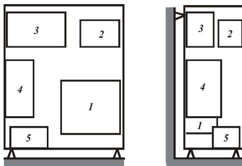
Рисунок 8 – Конструктивная схема корпуса блока: 1 – 5 – номера функциональных узлов
