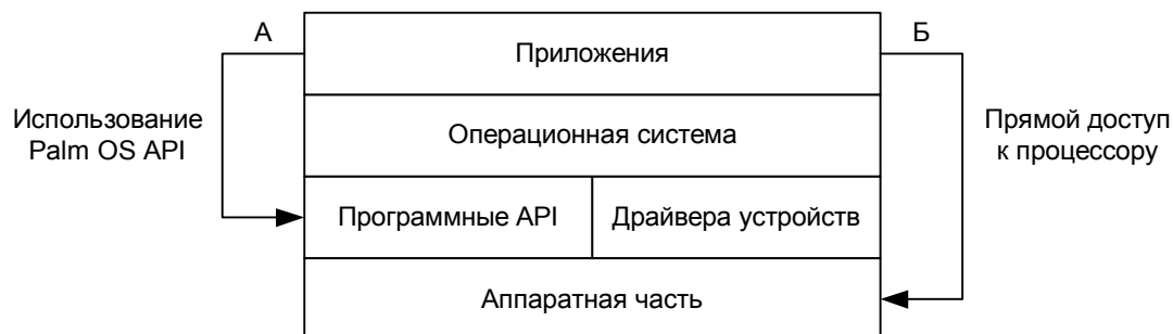
Рисунок 1 – Типовая уровневая архитектура PDA
