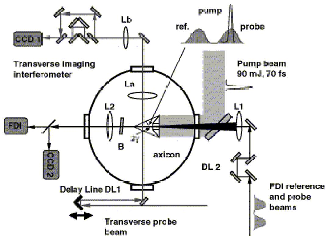
Transverse imaging interferometer – поперечно отображенный интерферометр; Pump ref – накачка опорного пучка; Pump probe – накачка пробного пучка; Pump beam 90 mJ, 70 fs – накачка пучка 90 мДж, 70 фс; axicon – осевой концентратор; Delay line DL1 (DL2) – линия задержки ЛЗ1 (ЛЗ2); FDI reference and probe beams – FDI опорный и пробный пучки; FDI – free dispersion impulse – бездисперсионный импульс; Transverse probe beam – поперечный пробный пучок
