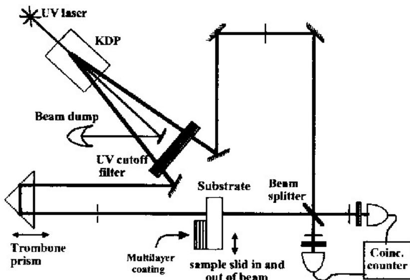
UVlaser – УФ-лазер; KDP – KDP-кристалл; Beam dump – демпфер пучка; UV cutoff filter – УФ обрезаящий фильтр; Substrate – подложка; Beam splitter – светоделитель (расщепитель пучка); Trombone prism – призма в виде тромбона; Multilayer coating – многослойное покрытие; Sample slid in and out beam –двигаемый в пучок и выдвигаемый из пучка (скользящий) образец; Coinc. Counter – счётчик совпадений
