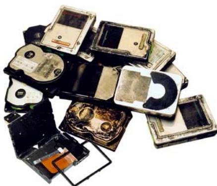
Рисунок 12 – Винчестеры компьютеров сгоревшего офиса. Информация была полностью восстановлена в сервисном центре ООО ЕПОС (2001 г.)
