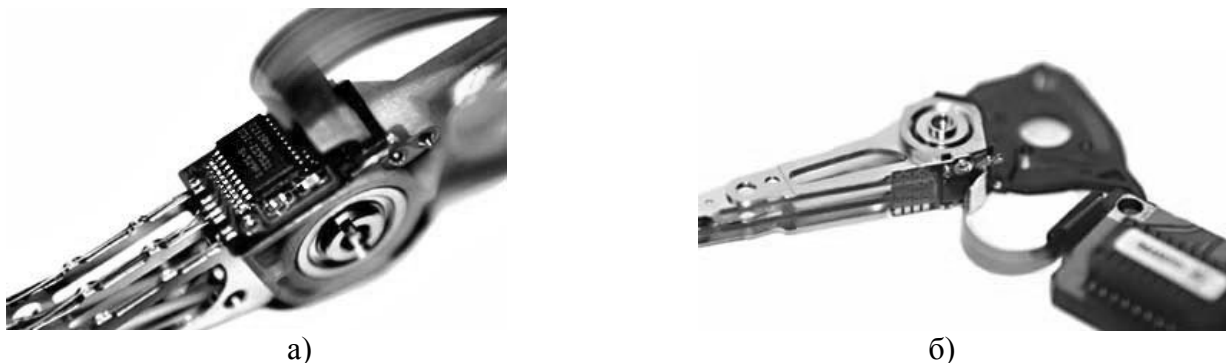
Рисунок 4 – Варианты исполнения блоков головок: а) с корпусным усилителем-коммутатором; б) с бескорпусным усилителем-коммутатором
