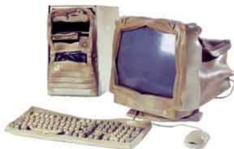
Рисунок 11 – Компьютер после пожара в помещении. Полностью восстановлен в ООО ЕПОС
