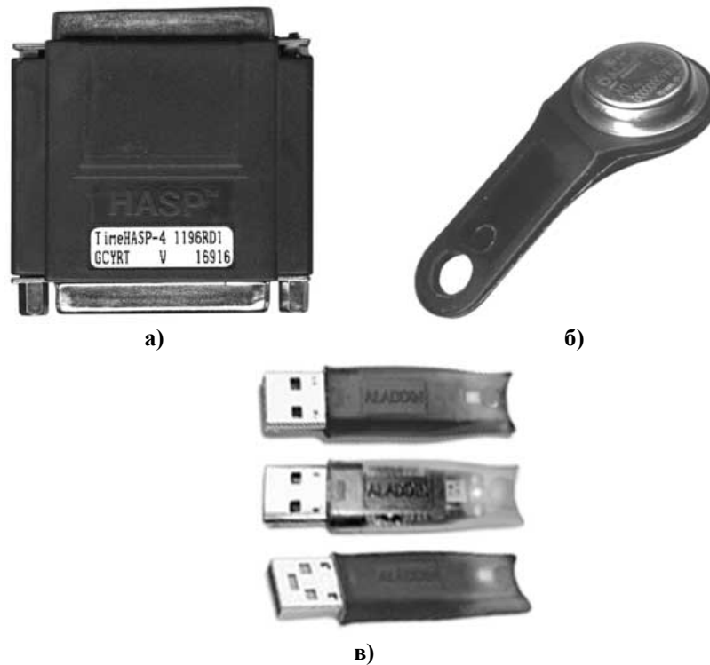
Рисунок 15 – Виды носителей ключевой информации: а) HASP; б) TouchMemory; в) e-Token
