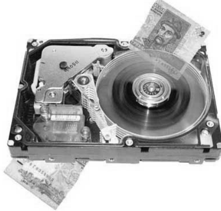
Рисунок 7 – Рабочий слой жесткого диска полностью уничтожен. Материал пластины – стекло
