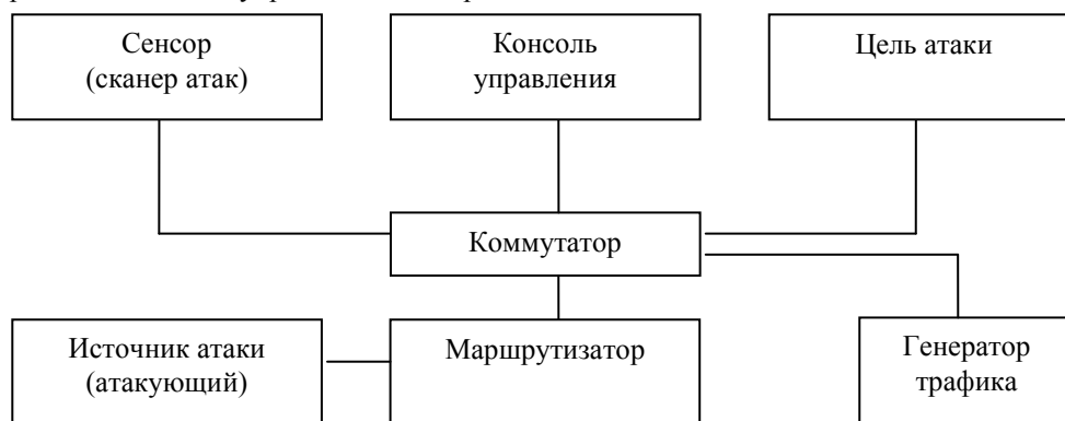
Рисунок 4 – Простейший состав стенда для тестирования сетевой системы обнаружения атак
