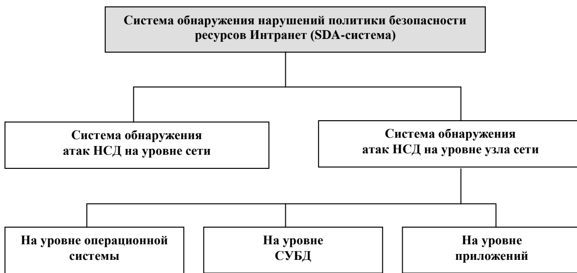
Рисунок 3 — Классификация систем обнаружения атак НСД по принципам (уровням) их реализации в Интранет
